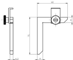
**820.2461** Equerre pour la mesure d'angles aigus
