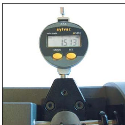
Mesure du déplacement vertical d'un élément
