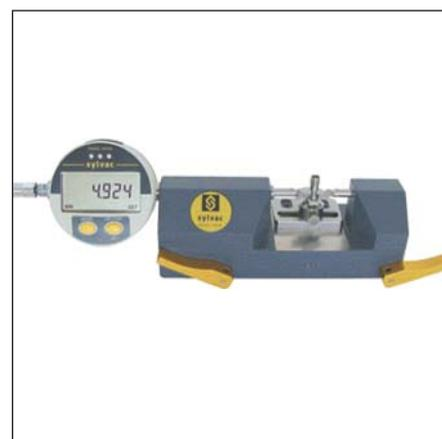
Utilisation d'un S213 avec un banc de mesure Sylvac PS15
