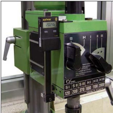
Mesure de profondeur sur une perceuse
