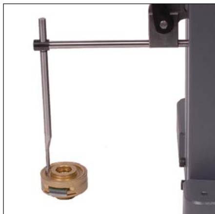
Mesure de profondeur avec accessoires 930.2108 et 930.2105
