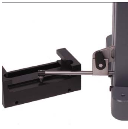
Mesure de profondeur avec accessoires 930.2108 et 905.2204
