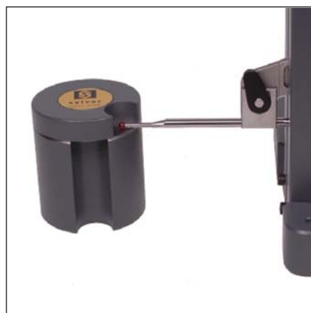
Prise de la valeur de constante avec le plot 930.2002 livré en standard
