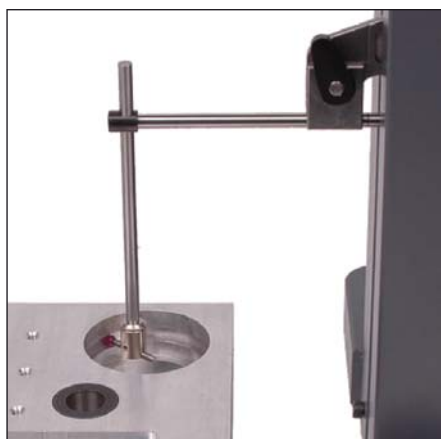
Mesure de gorge intérieure avec accessoires 930.2108, 930.2110 et 905.2207
