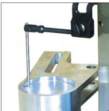
Mesure de gorges avec porte-touche à 90° et touche en « L »
