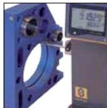
Mesure de diamètre intérieur avec touche bille rubis Ø 3 mm, 930.2101 livré en standard
