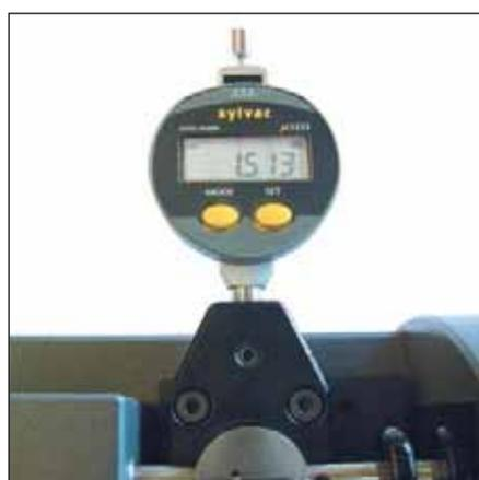
Mesure du déplacement vertical d'un élément
