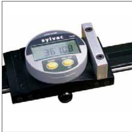
Butée d'arrêt montée sur le curseur
