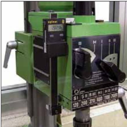
Mesure de profondeur sur une perceuse
