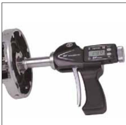
Mesure avec système XTH à pistolet
