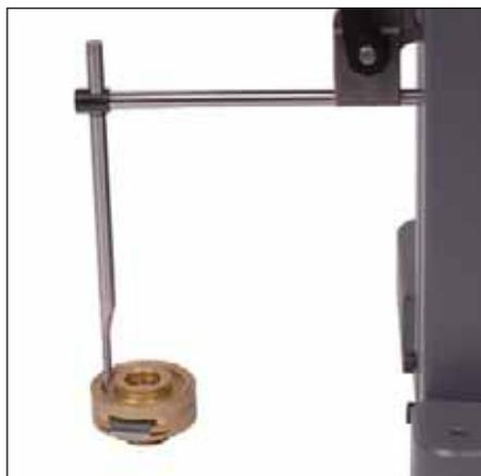
Mesure de profondeur avec accessoires
