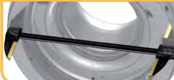
Mesure de larges diamètres intérieurs (jusqu'à 3m)
