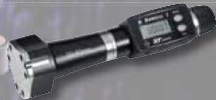
Sylvac a le grand plaisir de vous annoncer le lancement de la nouvelle série d'instruments de mesure intérieure à lecture digitale **XT-XTREME** équipé d'une électronique inductive avec protection IP65. Elle remplace l'actuelle série XT.
