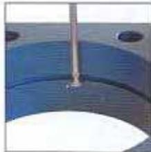
Mesure de rainure intérieure avec accessoires 930.2108, 900.2110 et 900.2205
