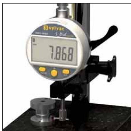
Mesure d'une portée avec un S_Dial WORK et la touche de mesure à bille type 905.2207
