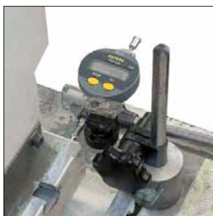
Mesure du déplacement vertical d'un élément
