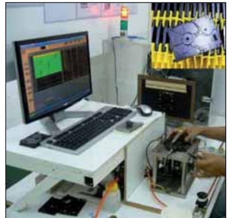
Mesure multi-cotes de chassis de disques durs
