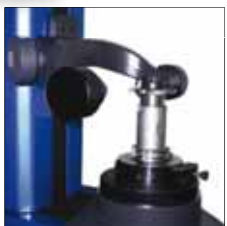
Mesure d'une fraise à 3 tailles
