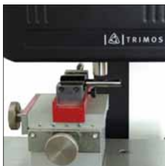
Mesure de rugosité sur un axe rectifié
