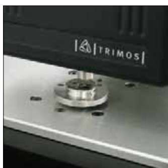
Mesure de texture d'une surface polie miroir
