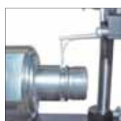
Mesure d'état de surface sur une pièce polie
