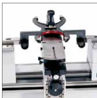
Contrôle de calibres-mâchoires de 12 à 150 mm
