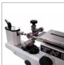
Vérification de tampons lisses et filetés avec table flottante
