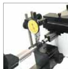
Etalonnage d'indicateurs à levier
