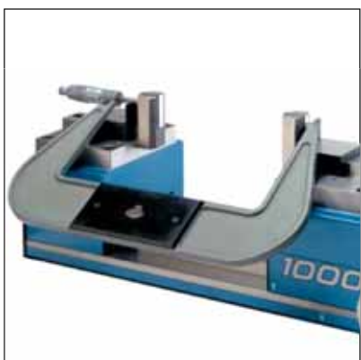
Vérification de micromètres extérieurs
