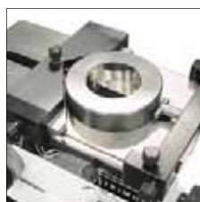
Mesure de diamètres intérieurs
