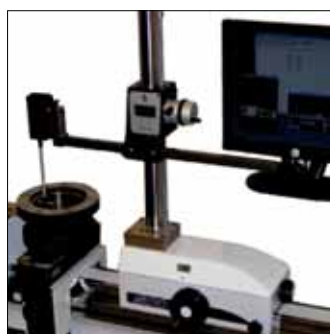
Exécution spéciale pour la mesure de grandes bagues et tampons filetés coniques
