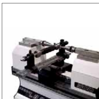
Contrôle de tampons filetés avec table flottante
