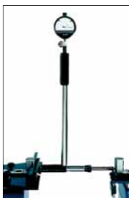
Etalonnage de vérificateurs d'alésages à 2 points
