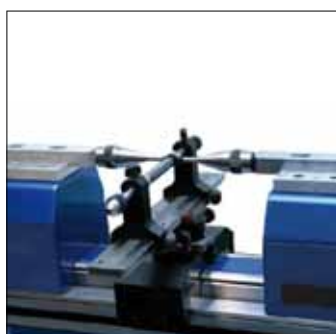
Vérification rapide de tampons lisses avec table flottante
