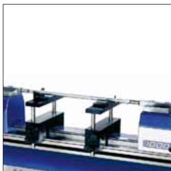
Etalonnage de vérificateurs d'alésages à deux points
