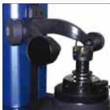
Mesure d'une fraise à surfaces
