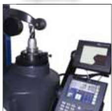
Mesure d'une fraise d'ébauche
