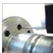
Mesure dans un alésage de faible diamètre
