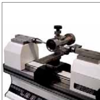
Contrôle de tampons lisses avec table flottante
