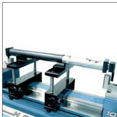
Etalonnage d'alésomètres à deux points
