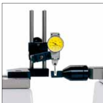
Contrôle de comparateurs à levier
