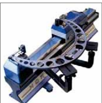
Contrôle de grands micromètres
