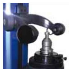
Changement d'une fraise à rayon concave
