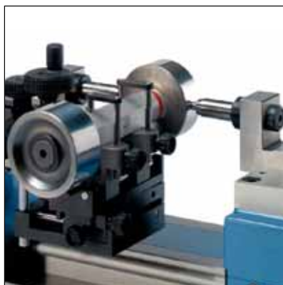
Vérification de tampons lisses
