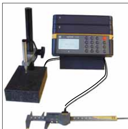
Mélange de palpeurs et d'instruments à main
