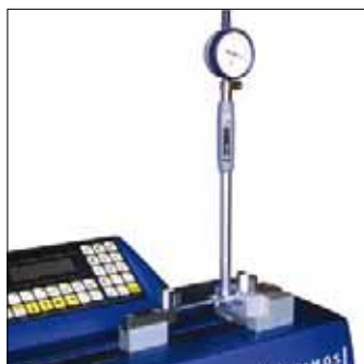
Etalonnage d'un vérificateur d'alésage
