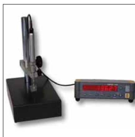
Mesure simple avec palpeur unique
