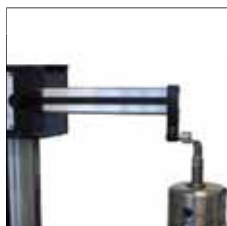
Mesure du diamètre d'un outil de coupe
