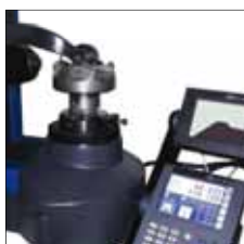
Mesure d'une fraise à plaquettes métal dur
