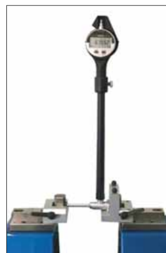
Etalonnage de vérificateurs d'alésage à deux points
