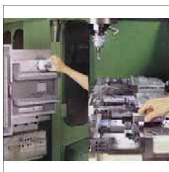
Mesure d'état de surface dans les deux configurations (unité d'avance en place dans l'électronique ou en dehors en utilisant la rallonge)
