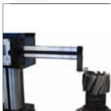
Mesure de la hauteur d'un outil de coupe
