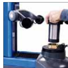
Changement d'un adaptateur
