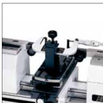
Contrôle et étalonnage de micromètres extérieurs
