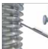
Mesure de rugosité dans une gorge
