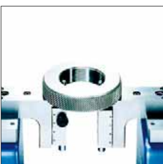
Contrôle de bagues filetées
