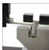
Contrôle de l'état de surface d'un tampon fileté
