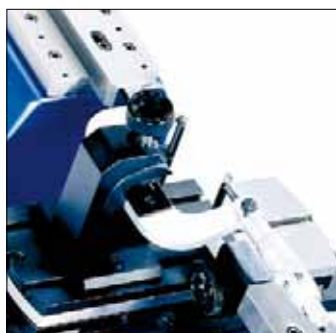
Contrôle de micromètres extérieurs
