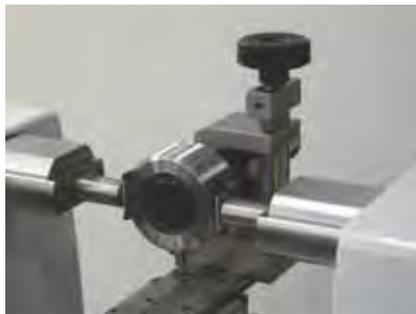
Etalonnage d'un tampon fileté
