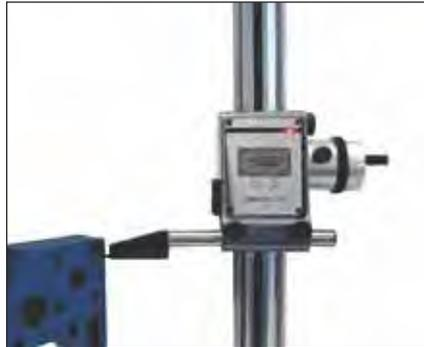
Mesure de diamètre avec touche bidirectionnelle (TVM4)
