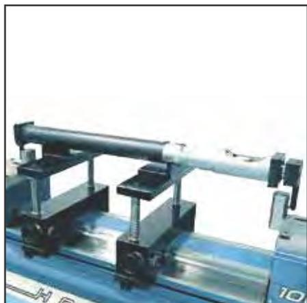
Étalonnage d'alésomètres à deux points
