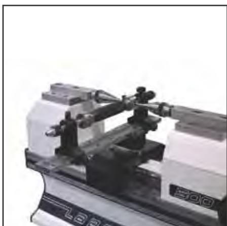
Contrôle de tampons filetés avec table flottante
