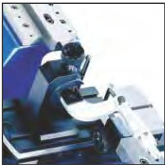
Contrôle de micromètres extérieurs
