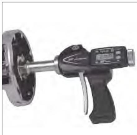
Mesure avec système XTH à pistolet
