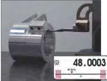
Mesure de diamètre avec aide graphique « EasyScan » (TA-MI-101/TA-AD-101)
