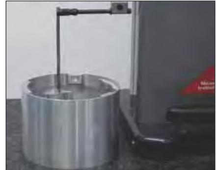
Mesure de profondeurs (TA-IH-109/V-50.5/V-50.4)
