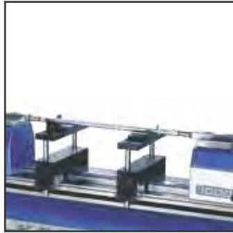
Etalonnage de vérificateurs d'alésages à deux points
