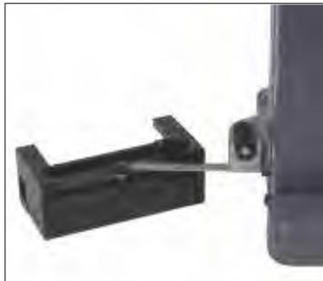
Mesure de profondeur avec accessoires 930.2108 et 930.2204
