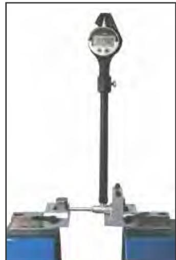
Etalonnage de vérificateurs d'alésage à deux points
