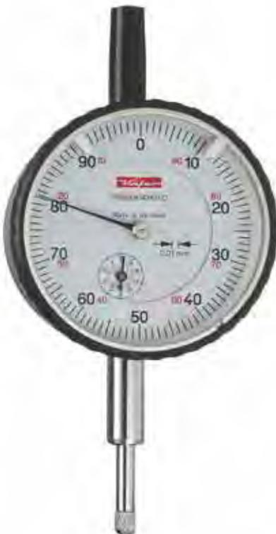
Réglage fin de l'aiguille par rotation du bouton moletée après dévissage du capuchon de protection
