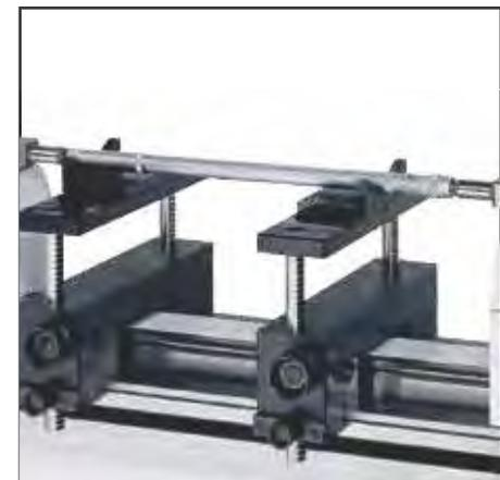
Étalonnage de vérificateurs d'alésage
