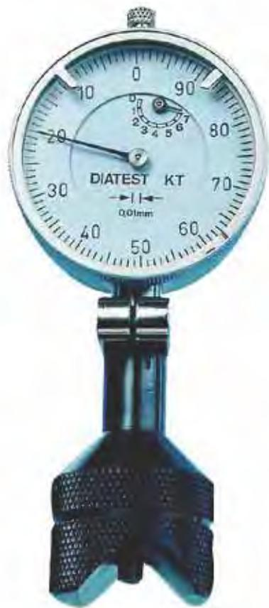
Vous mesurez directement des chanfreins de 45° sur des pièces rectangulaires ou circulaires ainsi que dans les alésages et rainures. Cet instrument de mesure sert également à comparer des chanfreins autre que 45°
