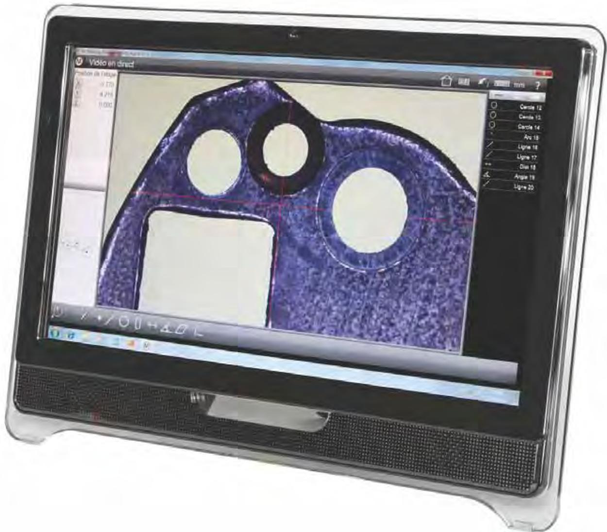
Le logiciel M3 est l'outil idéal pour réaliser des mesures rapides en série avec une caméra digitale et un système d'analyse d'image de la dernière génération.
