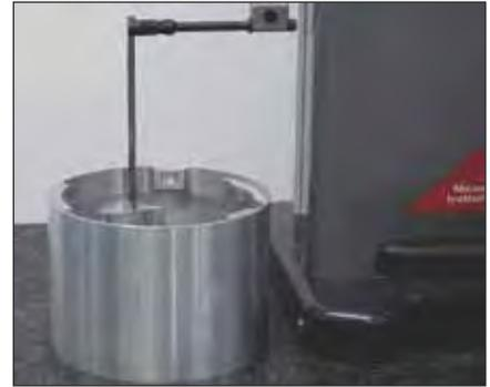
Mesure de profondeurs (TA-IH-109/V-50.5/V-50.4)
