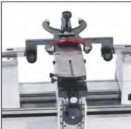
Contrôle de calibres-mâchoires de 12 à 150 mm
