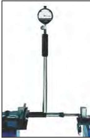
Etalonnage de vérificateurs d'alésages à 2 points
