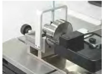
Etalonnage d'un tampon à filetage conique
