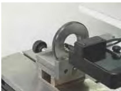
Contrôle d'une bague à filetage
