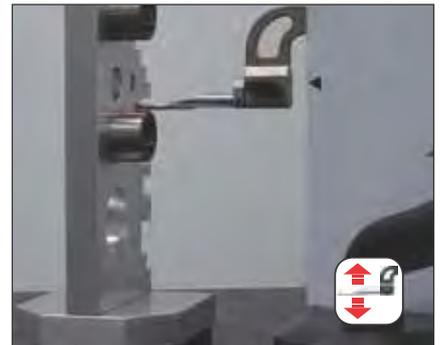
Mesure de diamètres extérieurs automatique avec « TRIMOS® NC movement » (TA-MI-101/TA-AD-101)
