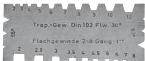
**filets plats et trapézoïdaux**
