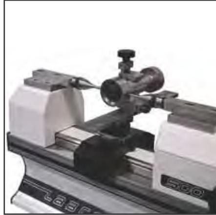
Contrôle de tampons lisses avec table flottante
