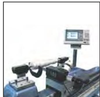
Accessoire pour la mesure de pièces cylindriques
