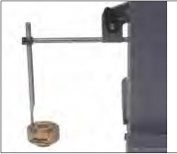
Mesure de profondeur avec accessoires 930.2108 et 930.2105
