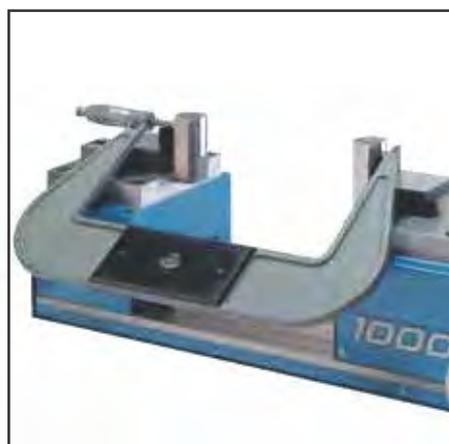
Vérification de micromètres extérieurs
