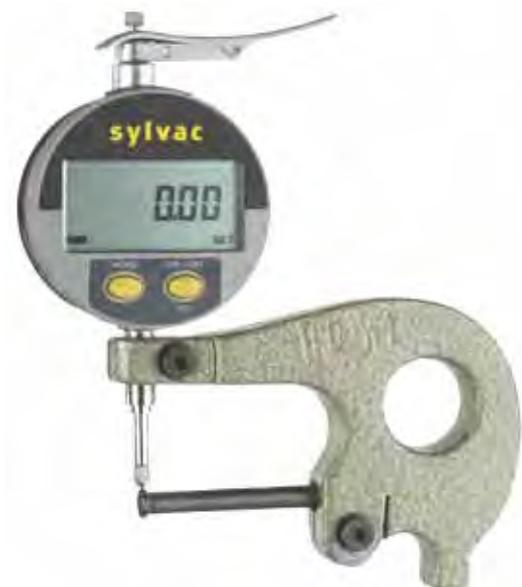
Touche inférieure - pique  $\varnothing$  6 mn avec rayon 1 mn pour la mesure des parois de tuyaux
