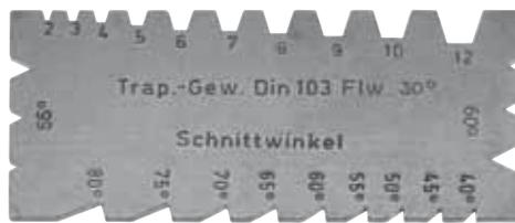
**filetage trapézoïdaux, Withworth et métrique**
