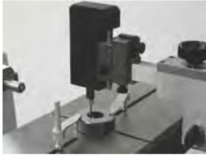
Etalonnage d'une petite bague lisse
