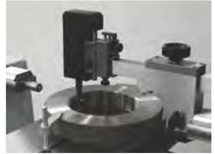
Contrôle d'une bague fileté
