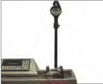
Etalonnage d'un vérificateur d'alésage
