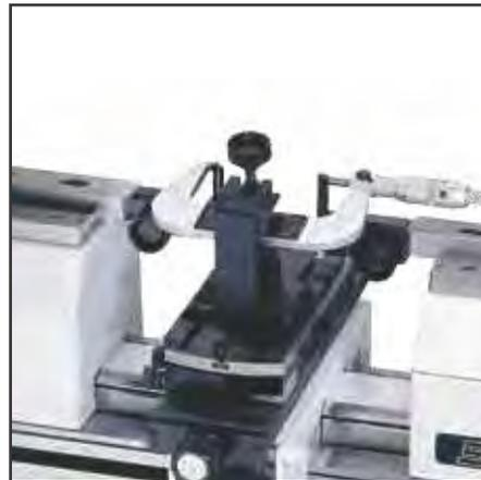
Contrôle et étalonnage de micromètres extérieurs
