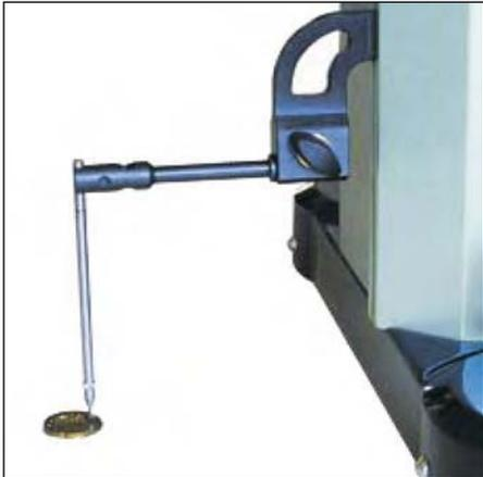
Mesure de hauteurs sur platine de montre
