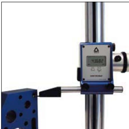
Mesure de diamètre avec touche bidirectionnelle
