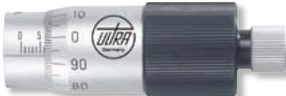
Lecture 0,01 mm, pas de vis micrométrique 1,0 mm (100 graduations tracées sur le tambour, lecture sans addition)
