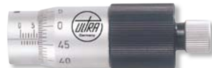
Lecture 0,005 mm, pas de vis micrométrique 0,5 mm (100 graduations tracées sur le tambour)
