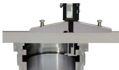
Anwendung mit verschiebbare Messbrücke Application with moveable measuring bridge
