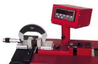
Kontrolle von Bügelmessschrauben Inspection of external micrometers
