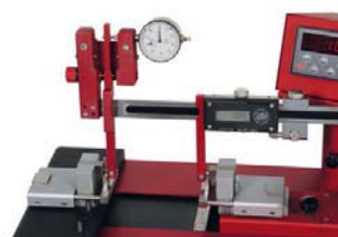
Voreinstellen von Vergleichsmessgeräten Pre-setting of universal calipers
