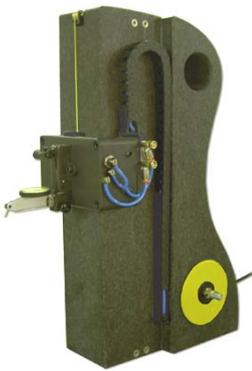
Le ROCKO, instrument de contrôle de perpendicularité à l'aide d'un comparateur (non fourni), est composé :
