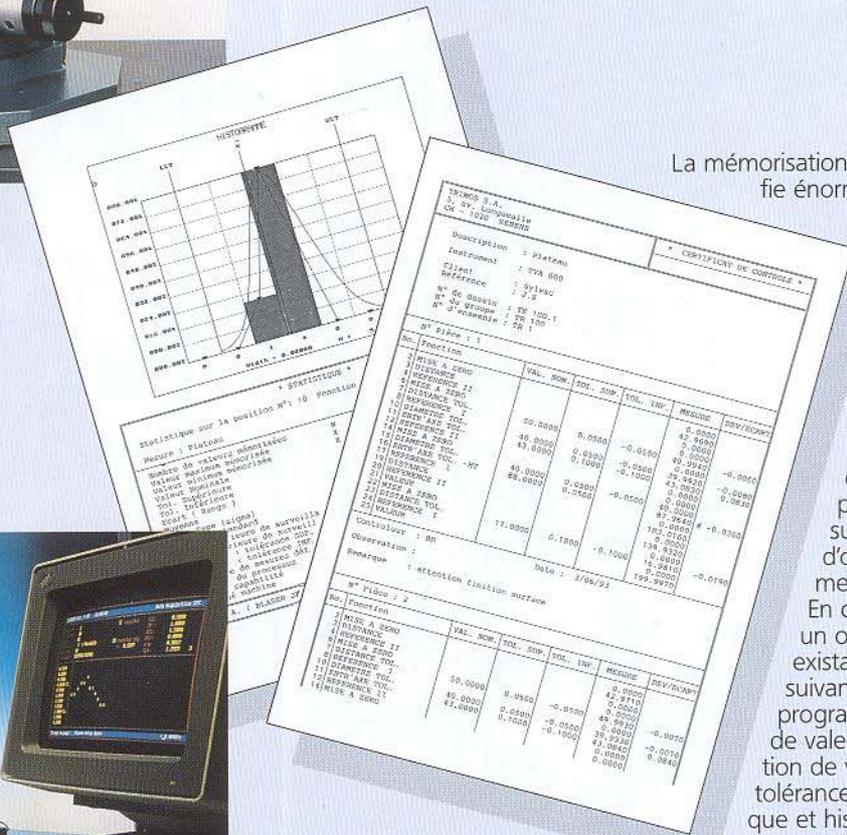
La mémorisation d'un programme simplifie énormément la mesure de pièces en séries. La première pièce est mesurée avec toutes les informations nécessaires et les suivantes seront réalisées sans devoir actionner à nouveau les touches de fonction.
