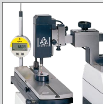
Contrôle de bagues lisses
