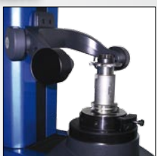
Mesure d'une fraise à 3 tailles
