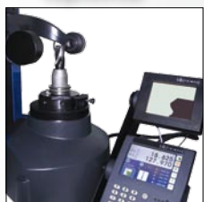
Mesure d'une fraise d'ébauche
