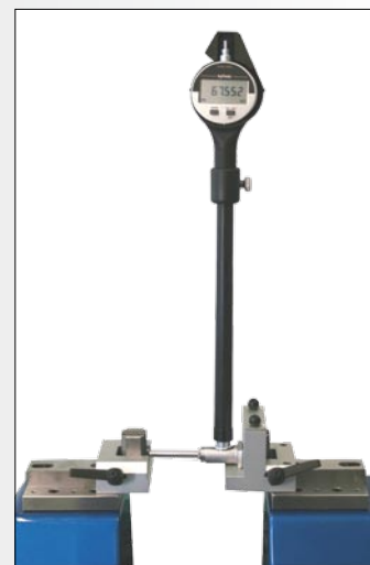
Etalonnage de vérificateurs d'alésage à deux points
