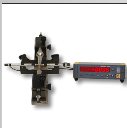
Mesure d'un axe
