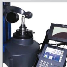
Mesure d'une fraise hémisphérique
