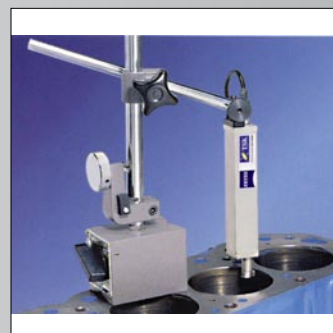
Unité d'avance sur un support de comparateur pour faciliter les prises de mesures délicates
