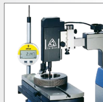
Contrôle de bagues filetées
