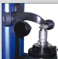
Mesure d'une fraise de forme 90°
