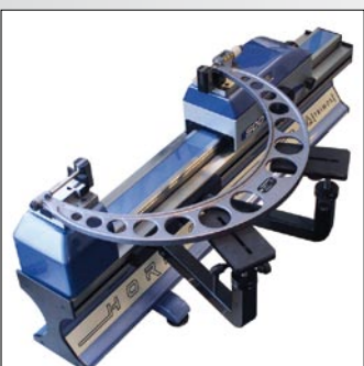
Contrôle de grands micromètres
