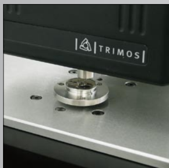
Mesure de texture d'une surface polie miroir
