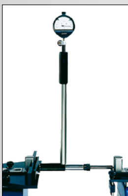
Etalonnage de vérificateurs d'alésages à 2 points
