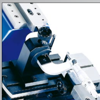
Contrôle de micromètres extérieurs
