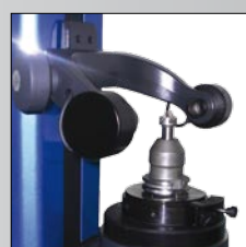
Changement d'une fraise à rayon concave
