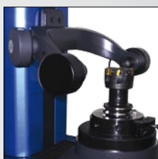
Mesure d'une fraise à surfaces
