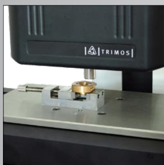
Mesure de rugosité sur une entretoise de précision
