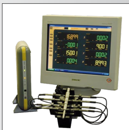
Mesure en dynamique des différents diamètres, malrond et concentricité d'un axe
