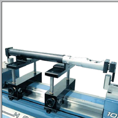
Etalonnage d'alésomètres à deux points
