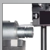
Mesure de rugosité proche d'un épaulement
