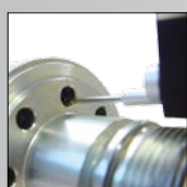
Mesure dans un alésage de faible diamètre
