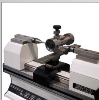
Contrôle de tampons lisses avec table flottante
