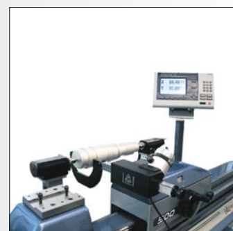
Accessoire pour la mesure de pièces cylindriques
