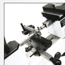
Mesure de diamètres extérieurs et de tampons filetés
