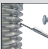
Mesure de rugosité dans une gorge
