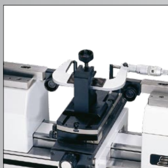
Contrôle et étalonnage de micromètres extérieurs
