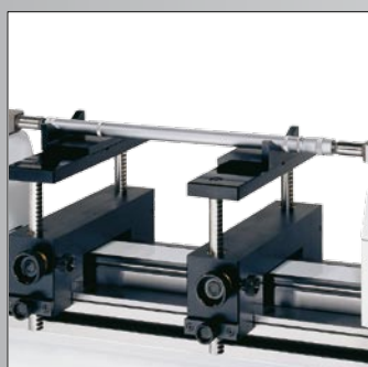
Étalonnage de vérificateurs d'alésage
