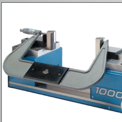
Vérification de micromètres extérieurs
