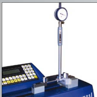
Etalonnage d'un vérificateur d'alésage
