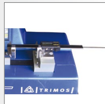
Le contrôle de pied à coulisse, micromètres et comparateurs est également possible
