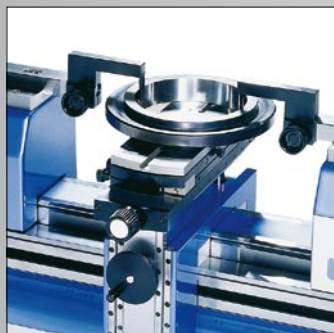
Contrôle de bagues lisses
