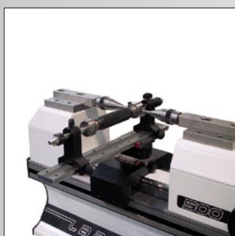
Contrôle de tampons filetés avec table flottante
