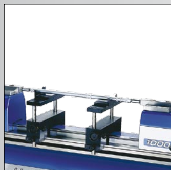
Etalonnage de vérificateurs d'alésages à deux points
