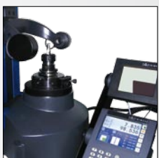
Mesure d'une fraise
