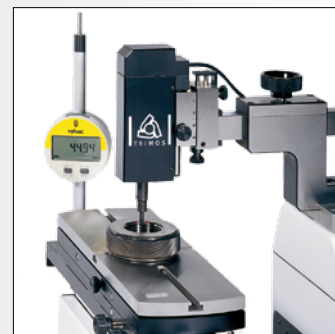
Contrôle de bagues filetées
