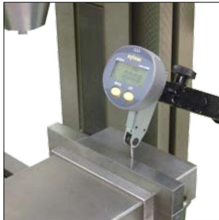
Vérification de l'alignement d'un étau de fraiseuse
