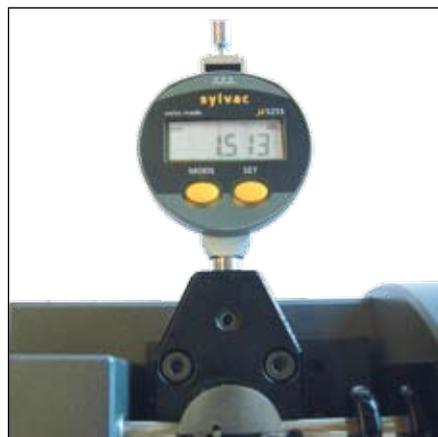
Mesure du déplacement vertical d'un élément
