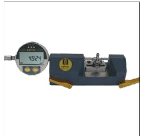
Utilisation d'un S213 avec un banc de mesure Sylvac PS15
