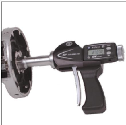
Mesure avec système XTH à pistolet
