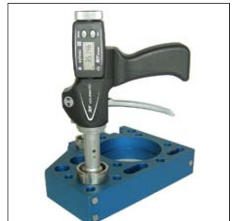
Mesure avec système XTH à pistolet
