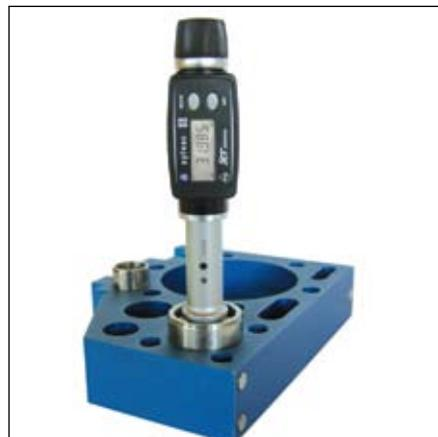
Mesure avec système XTD à rochet
