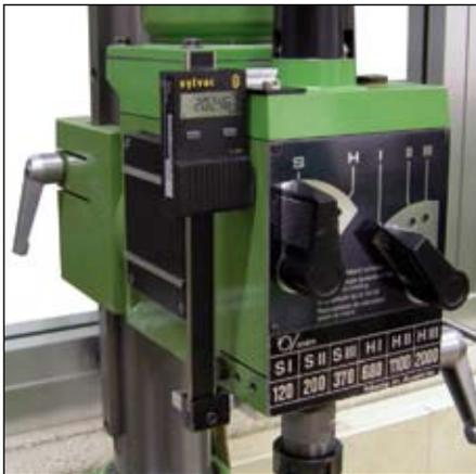
Mesure de profondeur sur une perceuse
