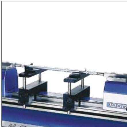
Etalonnage de vérificateurs d'alésages à deux points
