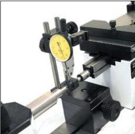
Etalonnage d'indicateurs à levier
