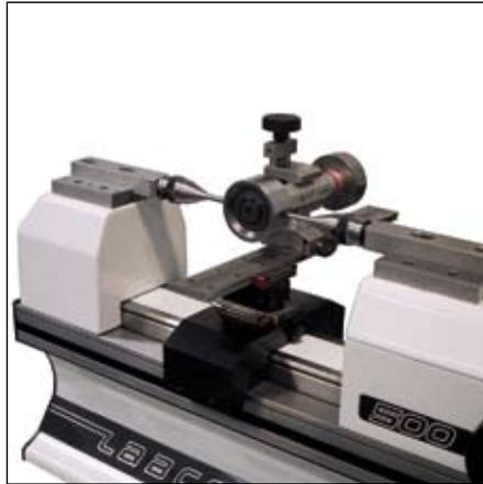
Contrôle de tampons lisses avec table flottante
