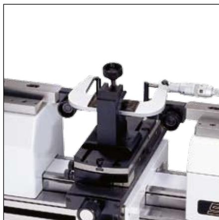
Contrôle et étalonnage de micromètres extérieurs
