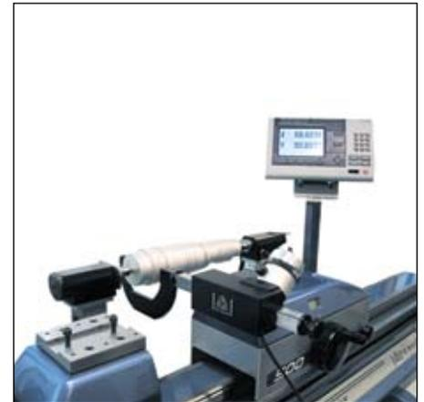
Accessoire pour la mesure de pièces cylindriques
