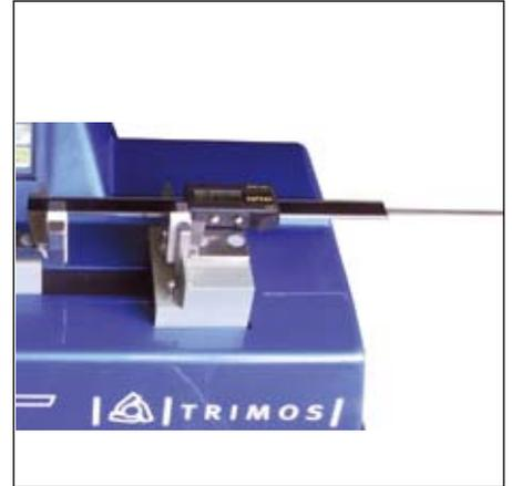
Le contrôle de pied à coulisse, micromètres et comparateurs est également possible
