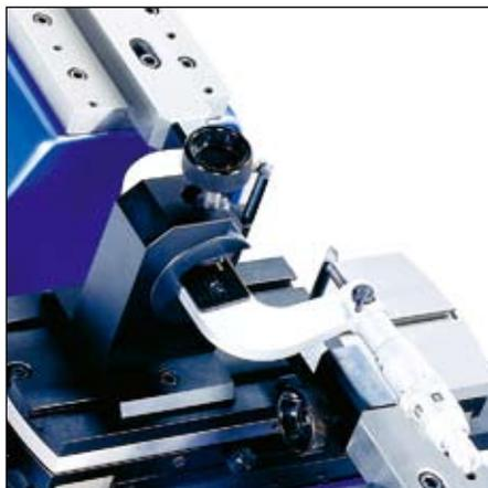
Contrôle de micromètres extérieurs
