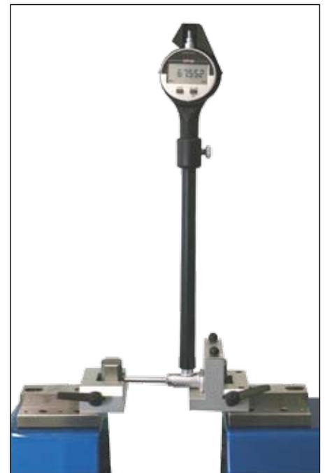
Etalonnage de vérificateurs d'alésage à deux points
