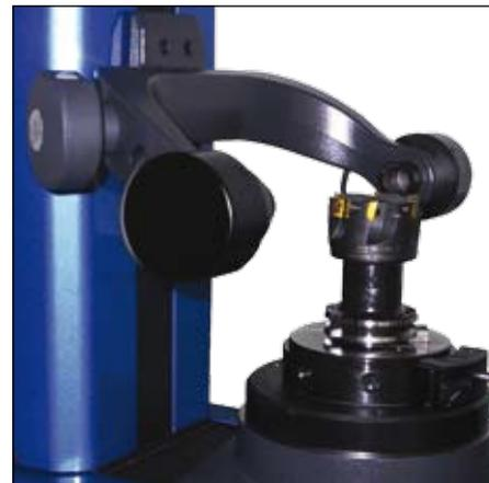
Mesure d'une fraise à surfaces
