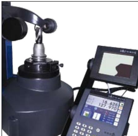
Mesure d'une fraise d'ébauche
