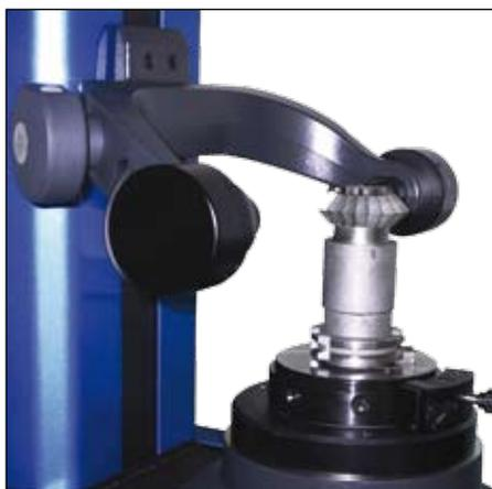
Mesure d'une fraise de forme 90°
