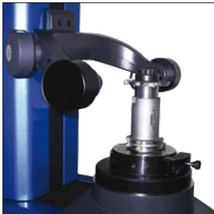
Mesure d'une fraise à 3 tailles
