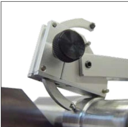
Mesure de rugosité radiale
