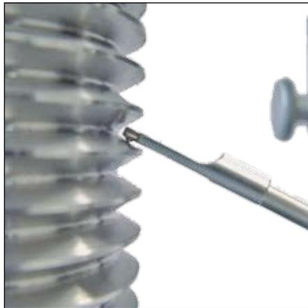
Contrôle de l'état de surface d'un tampon fileté
