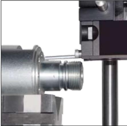
Mesure de rugosité proche d'un épaulement
