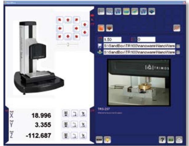
La mesure avec un TR Scan s'effectue de manière extrêmement simple et conviviale. Tout le processus de mesure est automatisé ainsi que l'analyse des résultats grâce à des modèles prédéfinis. Les tables motorisées à 1 ou 2 axes permettent la mesure sur de grandes surfaces par combinaison d'images (stitching).
