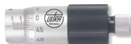
Lecture 0,005 mm, pas de vis micrométrique 0,5 mm (100 graduations tracées sur le tambour)
