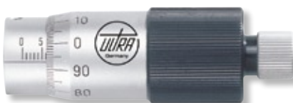
Lecture 0,01 mm, pas de vis micrométrique 1,0 mm (100 graduations tracées sur le tambour, lecture sans addition)
