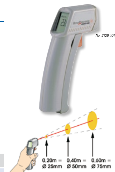
Optique standard 8:1 Point de mesure Ø 25 mm à 0,2 m Point de mesure Ø 75 mm à 0,6 m
