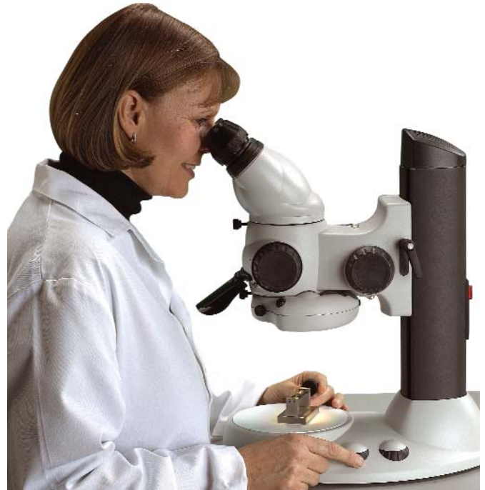
Microscope Bêta avec statif de table et éclairage intégral situé sous la platine.
