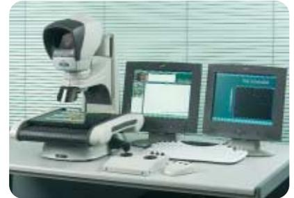
**Système Hawk 9** Système entièrement automatique avec configuration Hawk 7. Le QC5000 peut contrôler les mouvements XYZ, l'autofocus et le VED (video edge detection). Un boîtier abrite le système à fibre optique et les commandes des moteurs. Asservissement de l'éclairage.
