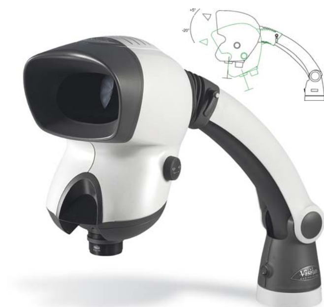
Mantis Elite, avec son statif universel à contrepoids et sa potence inclinable à 25° offre une meilleure flexibilité et une plus grande simplicité d'utilisation.
