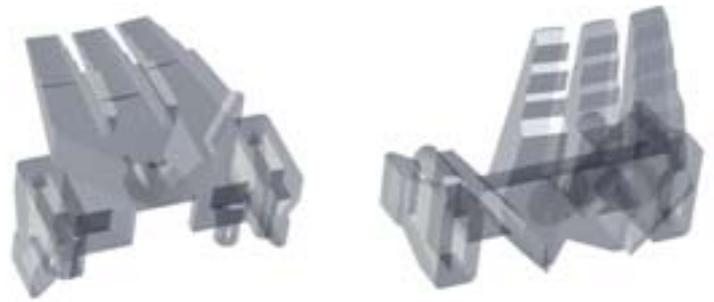
*Le conduit de lumière d'un fournisseur automobile de forte notoriété – ci-dessous les données CAO du logiciel de simulation – a été contrôlé par la Métrotomographie sur son bon fonctionnement.*
