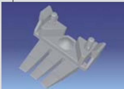
Si des données CAO sont réclamées de nouveau, par exemple parce que le procédé de moulage à été changé, le logiciel calcule à travers le modèle un nuage de points. Splines et nœuds sont générés par rétro conception, fournissant un modèle CAO complet à la fin de la procédure.
